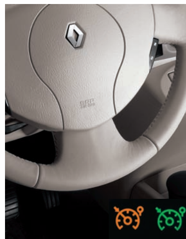
Régulateur limiteur de vitesse avec commandes au volant : il permet de sélectionner une vitesse constante (fonction régulateur) ou de se fixer une vitesse maximale (fonction limiteur).
