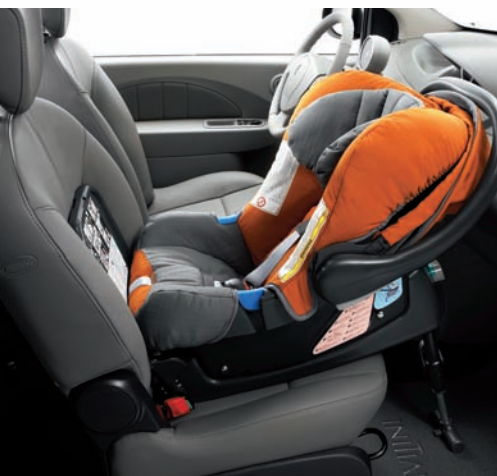
Systèmes de fixations Isofix pour sièges enfant dans l'assise du siège passager avant et arrière.
