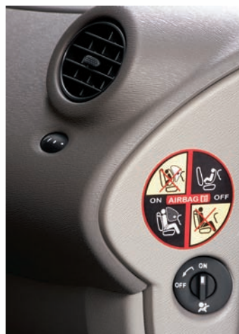
Déconnexion des airbags passagers avant, avec témoin sur tableau de bord, pour installer un siège enfant à l'avant en toute sécurité.
