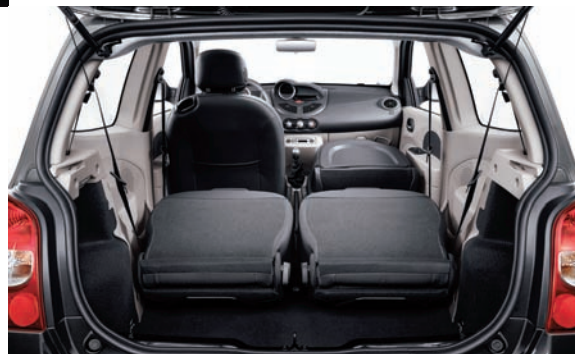
◀ Assise rabattable / coffre avec mise en break et mise en tablette du siège passager. Possibilité de charger un objet de plus de 2 m de long.
